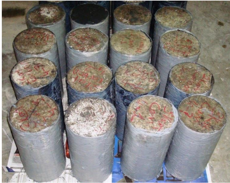
Şekil 2. FRP'ler ile güçlendirilen numuneler
