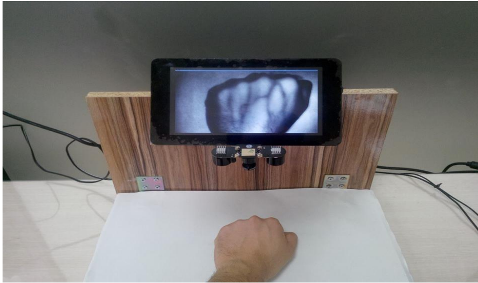
Şekil 5. Kurulu olan damar görüntüleme sistemi ve deneklerden el görüntüsü toplama aşaması
